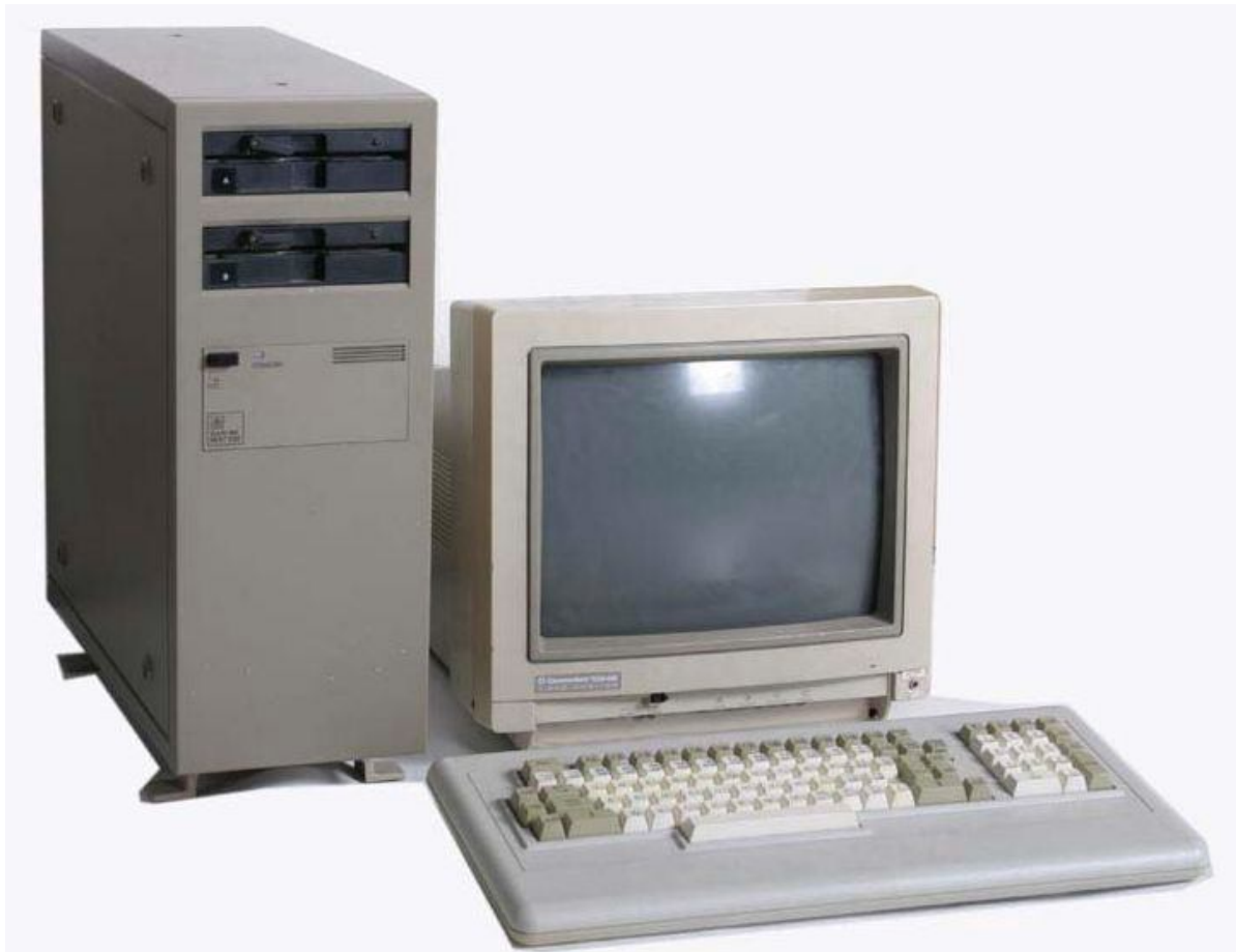
PC kompatibilní počítač SAPI 86 z Tesly Blatná připomíná „normální PC XT kompatibil“, má ale naprosto originální koncept desek, ze kterých je sestaven. (Zdroj: IC.cz)
