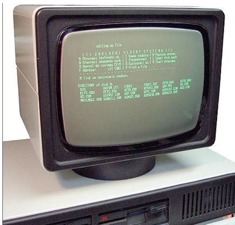
Východoněmecký Robotron 1715 kompatibilní s CP/M byl široce využíván podniky a řada jeho aplikací byla lokalizována do češtiny. (Zdroj: Old Computers)
