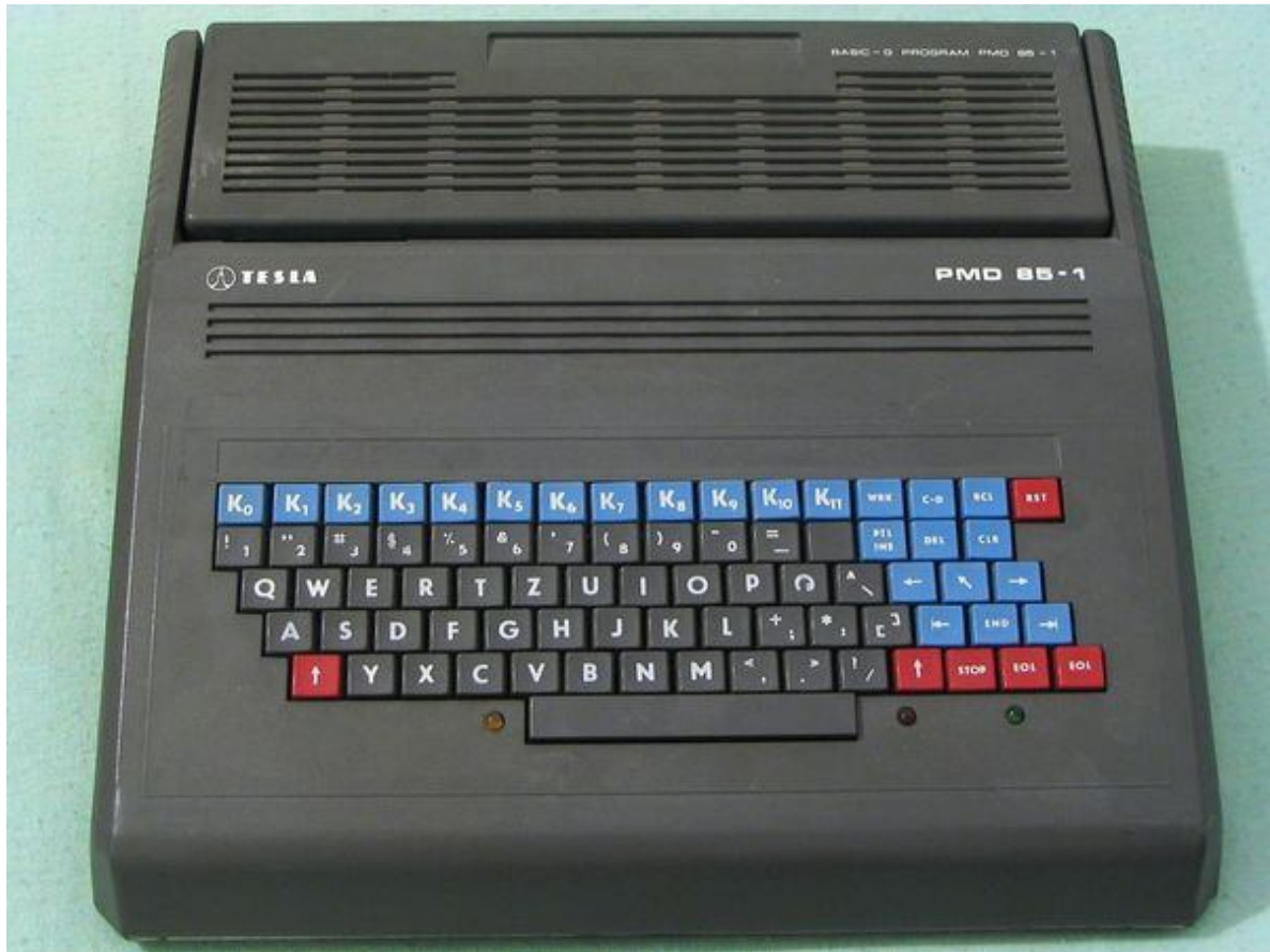
PMD 85.1 lze snadno rozeznat podle velmi tvrdé klávesnice vytvořené z telefonních tlačítek. (Zdroj: Wikipedia)
