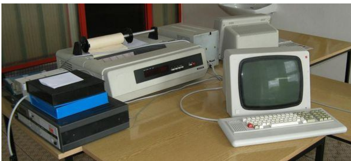
Typická výbava učebny se Zbrojováčky: Magnetofon SP210, dvojitá floppy mechanika a řádková tiskárna připojená k serveru, stanice jsou připojeny sítí. (Zdroj: Flickr)
