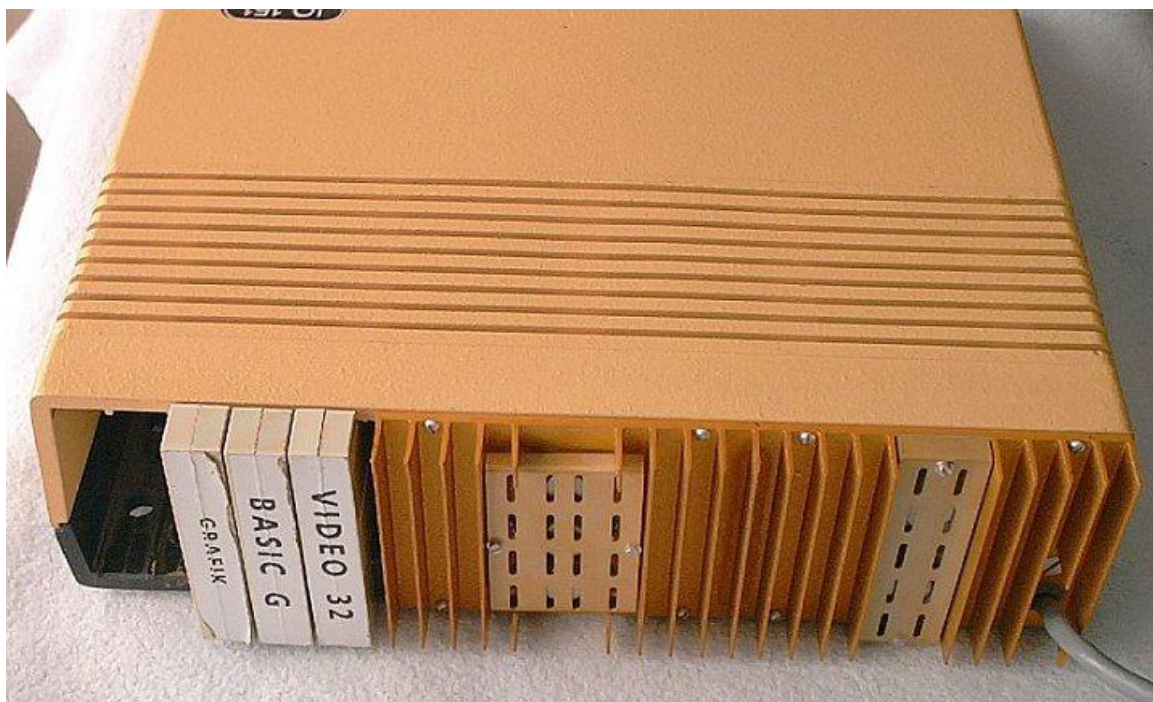
Moduly se zasouvaly do zadní části stroje. Standardní osazení „nové“ verze IQ-151: Modul Grafik, Basic určený pro práci s ním a znakové video. (Zdroj: Root.cz)
