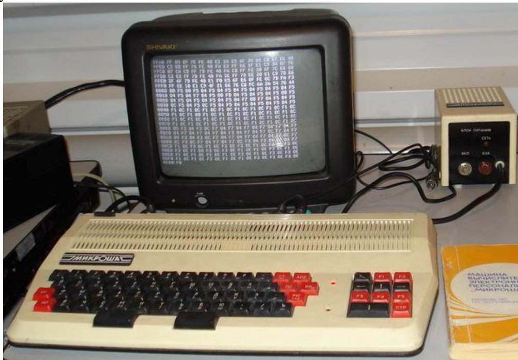
Ikonický sovětský domácí počítač Mikroša měl velmi zvláštní klávesnici – mezerník tvořily krátké zdvojené klávesy a kurzorové klávesy tvořily s funkčními klávesami chaotickou skrumáž. (Zdroj: Wikipedia)
