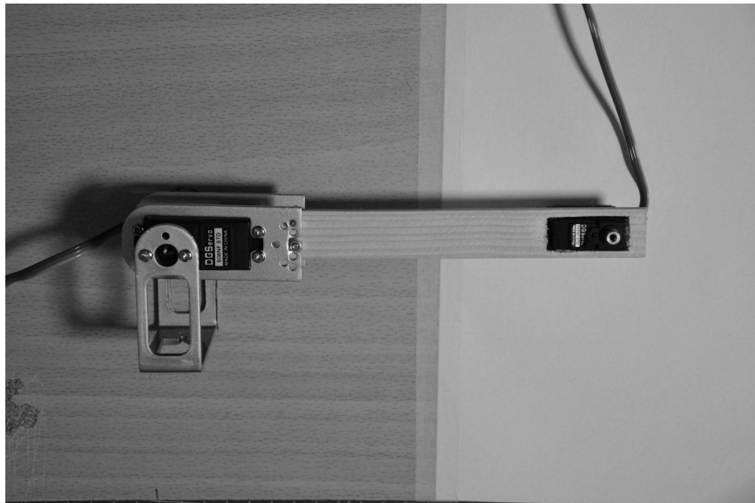
Obrázek 66.8: Připevnění kratšího ramene
