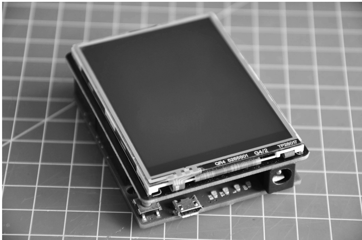
Obrázek 55.7: Arduino a TFT Shield
