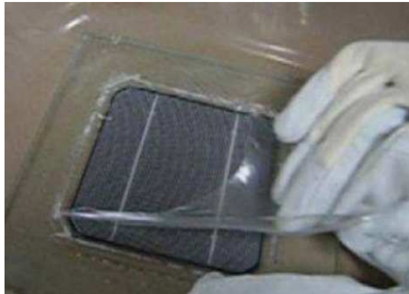
Odstranění laminátu EVA (etylen-vynil-acetát)
