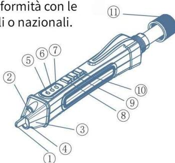
DProbe (testa del sensore NCV)
