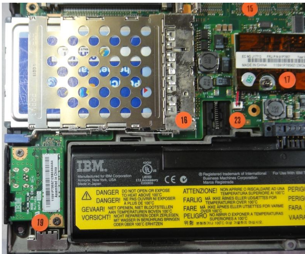
PCMCIA slot pro rozšiřující karty (16), baterie a její mechanické ukotvení (23), deska infračervené komunikace a FireWire 400 (19).
