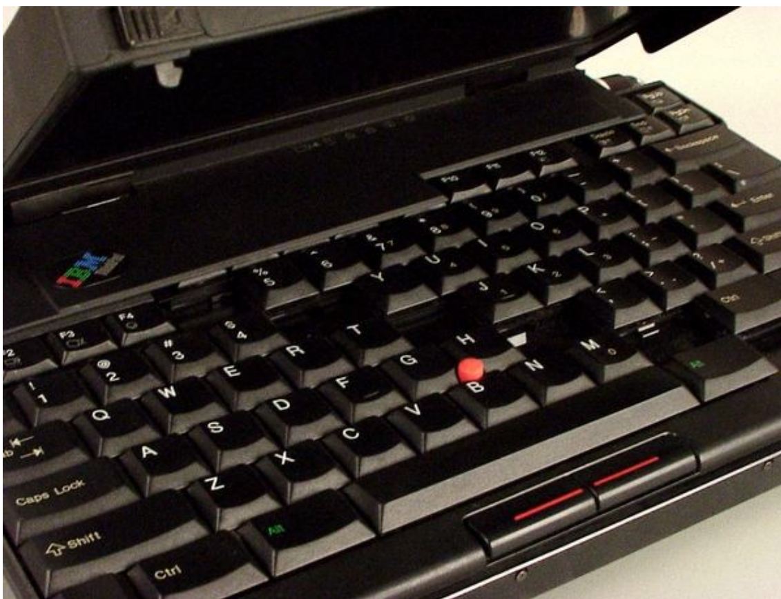
Klávesnice typu „butterfly“ uprostřed procesu zavírání: Pravý trojúhelníkový segment zajiždí dozadu a doleva, levý segment se posunuje směrem do středu. (Zdroj: Wikimedia)
