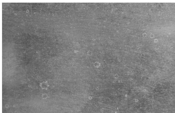
Obr. 3 Povrch Ag vzorku po expozici ve skladu
