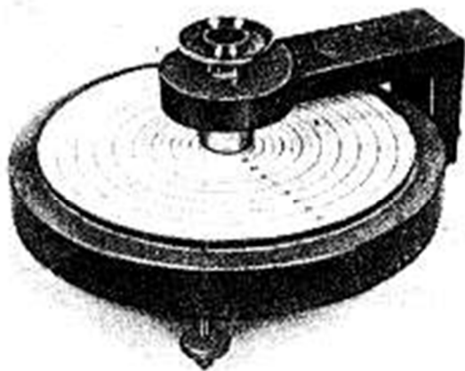
Obr. 11.4: Zařízení pro měření rozlévatelnosti / a - celkový pohled, b - detail odměrného válce /
