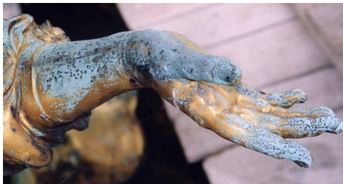
Obr. 31 Opotřevení zlatého povlaku na měděné plastice exponované ve vnějších podmínkách
