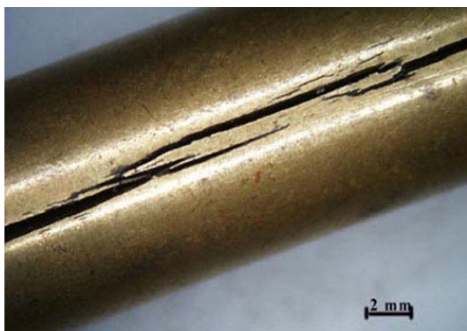
Obr.22a,b. Korozní praskání mosazi v důsledku vnitřního pnutí
