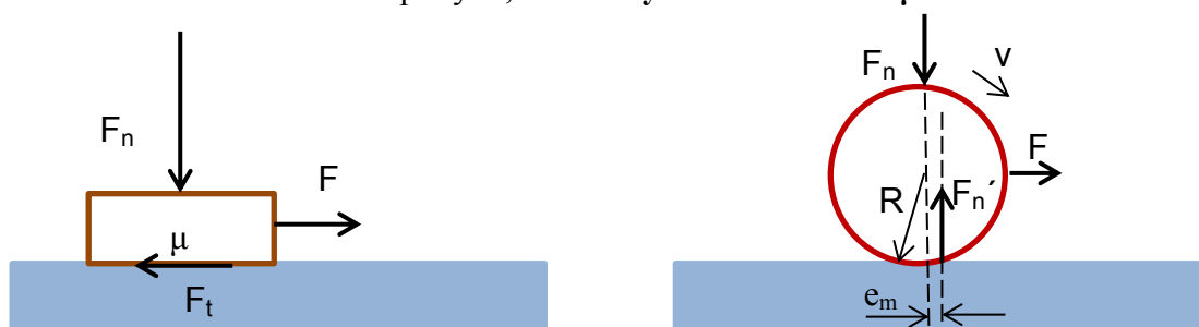
Obr. 6.1. Schéma pro definice součinitele kluzného a valivého tření.
